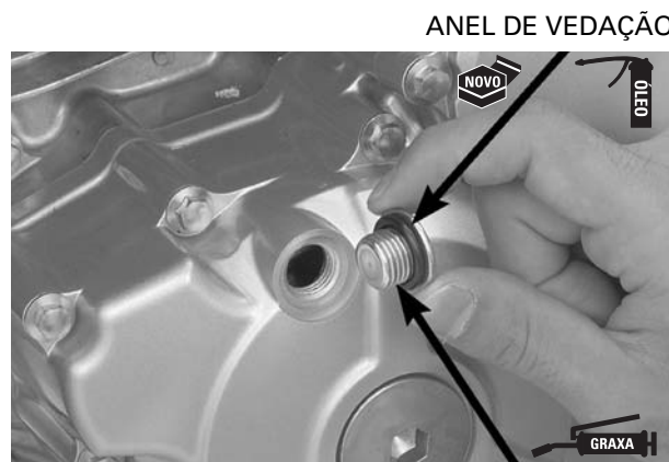
TAMPA DO ORIFÍCIO DE SINCRONIZAÇÃO
