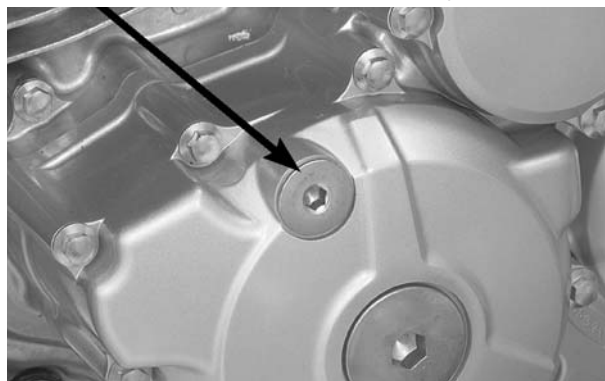
TAMPA DO ORIFÍCIO DE SINCRONIZAÇÃO
